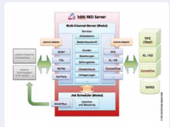
Der Multi-Channel-Server ist Teil des höttl Retail Enterprise Desktop (RED) und dient als Bindeglied zu den verschiedenen höttl Serversystemen, z.B. RFE, XL/ME, AIS, M.A.R.S. etc.
